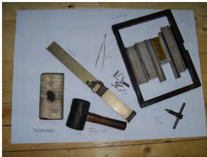
Peças e ferramentas da composição tipográfica. Fonte: caminhosentrelacados.blogspot.com
